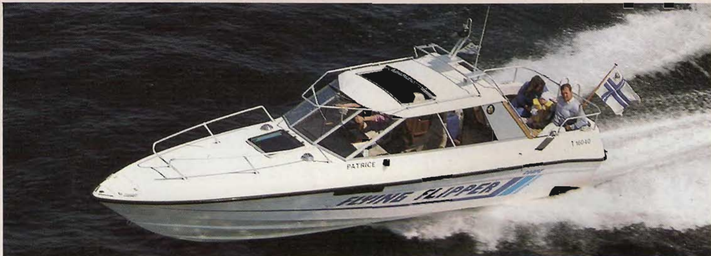
Flying Flipper Coupé: 9,05×2,6 m. Depl: 1.400 kg. Motor: 165—400 hp.
