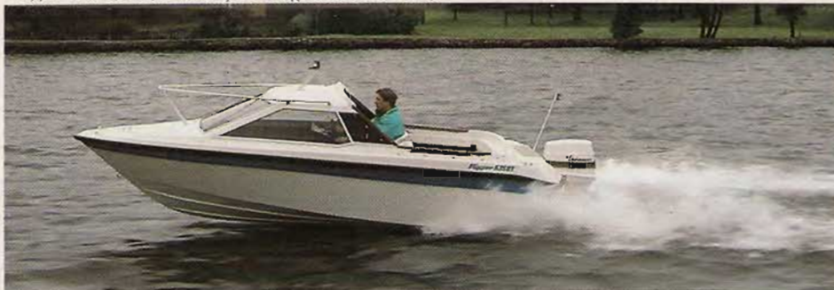
Flipper 535 HT: 5,33x2,02 m. Depl: 440 kg. Motor: 40-85 hp.
