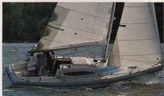
Inferno 29: 8,8×2,5 m. Depl: 2.500 kg. Motor: 9 hp. S-area: 38,5 m 2 .
