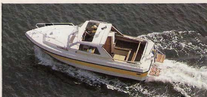
Flipper 700: 7,0×2,5 m. Depl: 1.600 kg. Motor: 110—165 hp.
