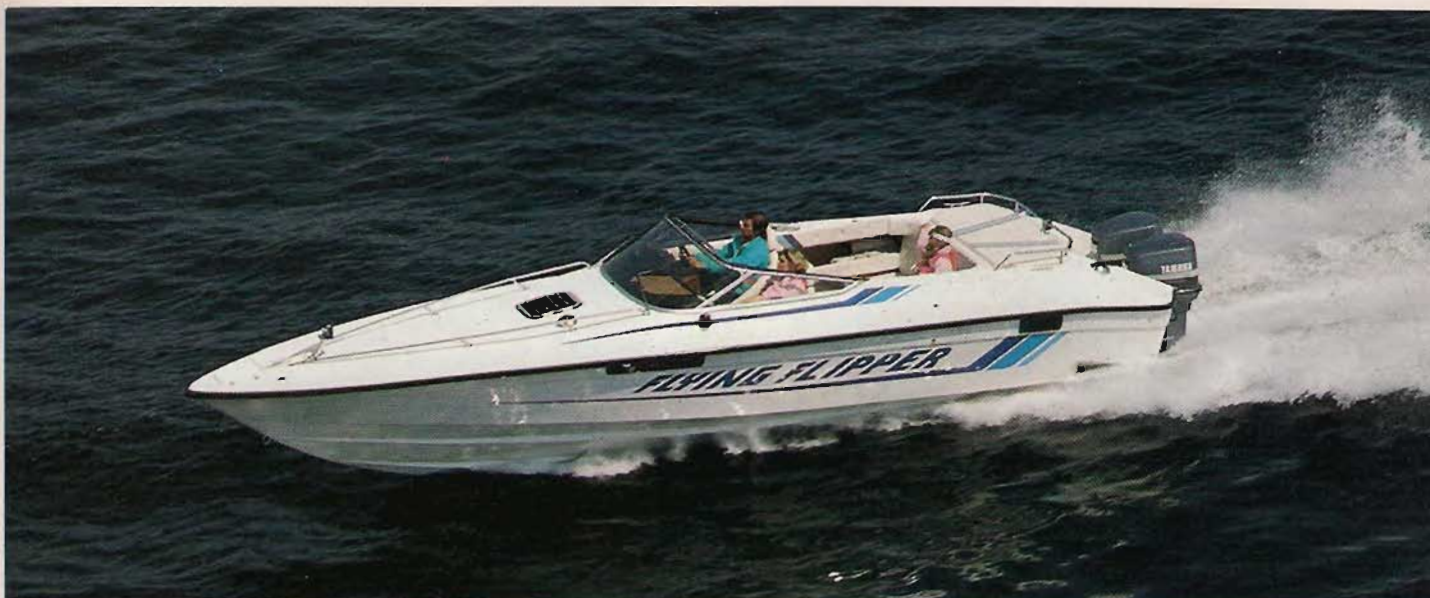
Flying Flipper: 9,05×2,6 m. Depl: 1.300 kg. Motor: 200—400 hp.
